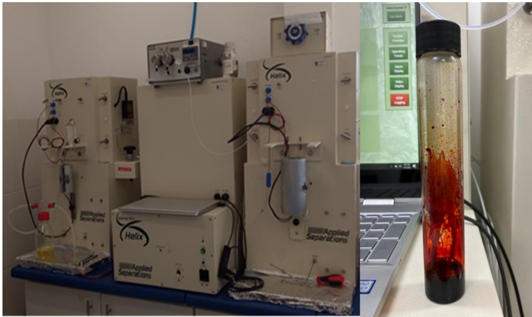
Equipo de Extracción Supercrítica Helix Applied Separations Spe-ed SFE (Fondequip EQM180201) y oleorresina de Astaxantina
